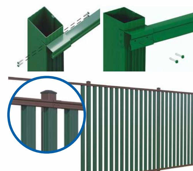
Каркас сплошного забора
